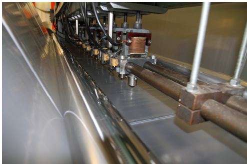
Abbildung 12: Darstellung des oberen Teils der Stößel-Matrizen-Systeme
