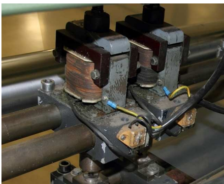
Abbildung 10: Darstellung der oberen beiden Führungsschienen der Magnetstanze inkl. Anbauten
