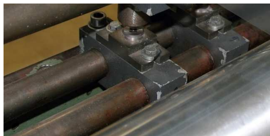
Abbildung 11: Darstellung der unteren beiden Führungsschienen der Magnetstanze inkl. Anbauten
