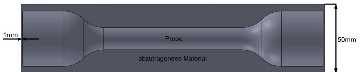
Abbildung 29: Spanabfall bei Rundmaterialdurchmesser 50 mm
