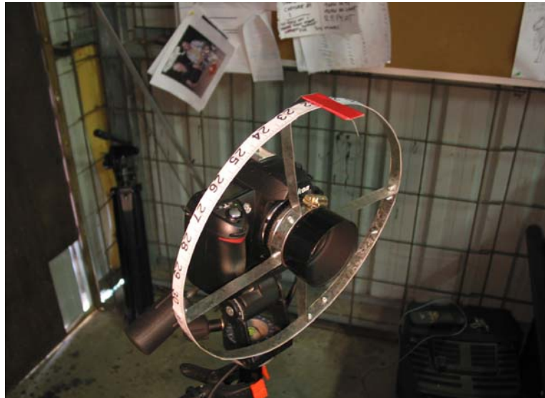
Abbildung 8: Wombok Forest: Fokusrad für eine höhere Kontrolle über eine Fokusverlagerung
