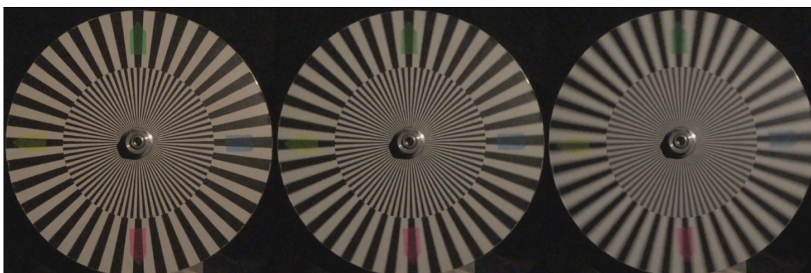
Abbildung 4: Rotierender Siemensstern bei verschiedenen Rotationsgeschwindigkeiten (0,15, 0,375, 0,94 U/s) und Aufnahme in 720p/120
