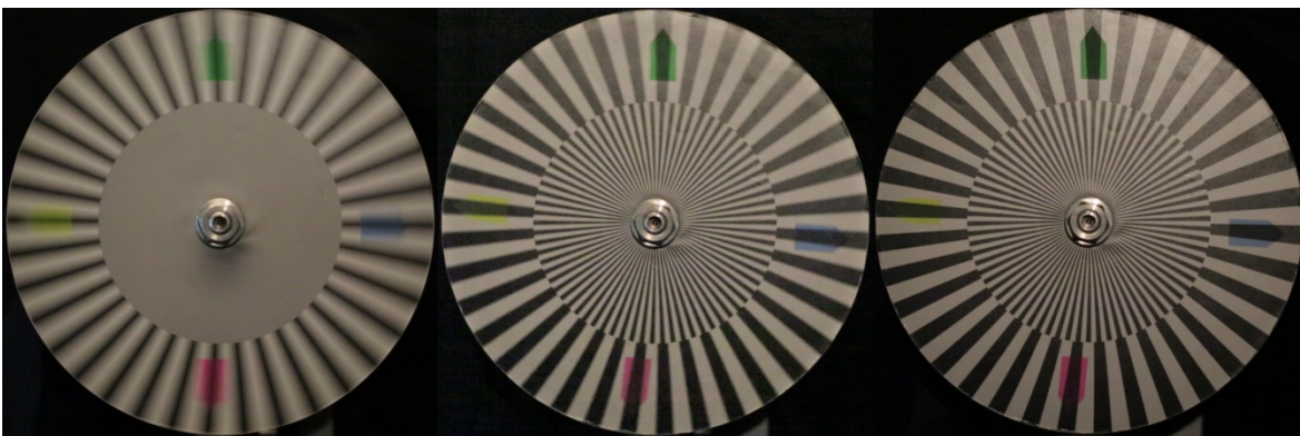
Abbildung 2: Rotierender Siemensstern bei verschiedenen Shutterwerten ( 1/50 , 1/200 , 1/1000 Sekunde) und Aufnahme in 1080p/25
