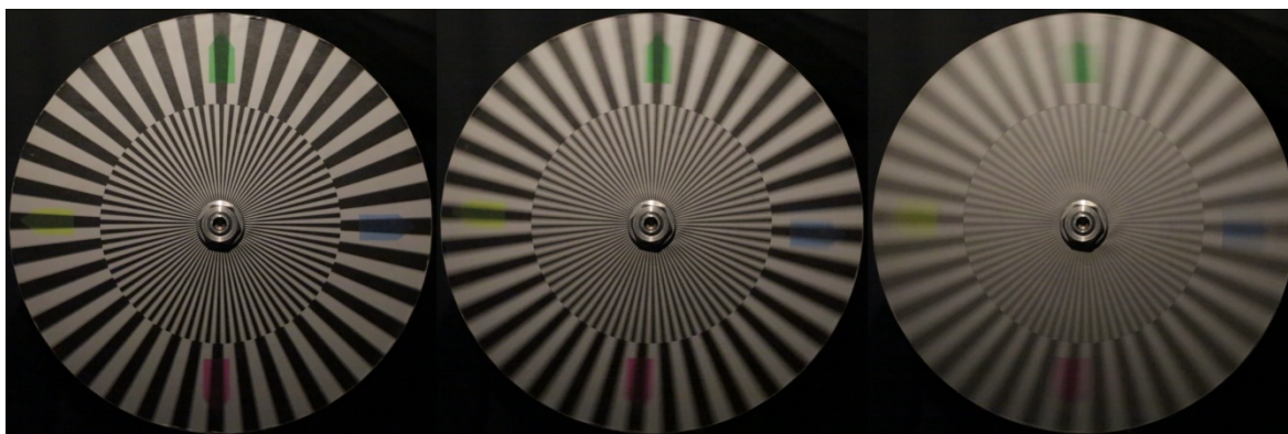
Abbildung 3: Rotierender Siemensstern bei verschiedenen Rotationsgeschwindigkeiten (0,15, 0,375, 0,94 U/s) und Aufnahme in 1080p/25
