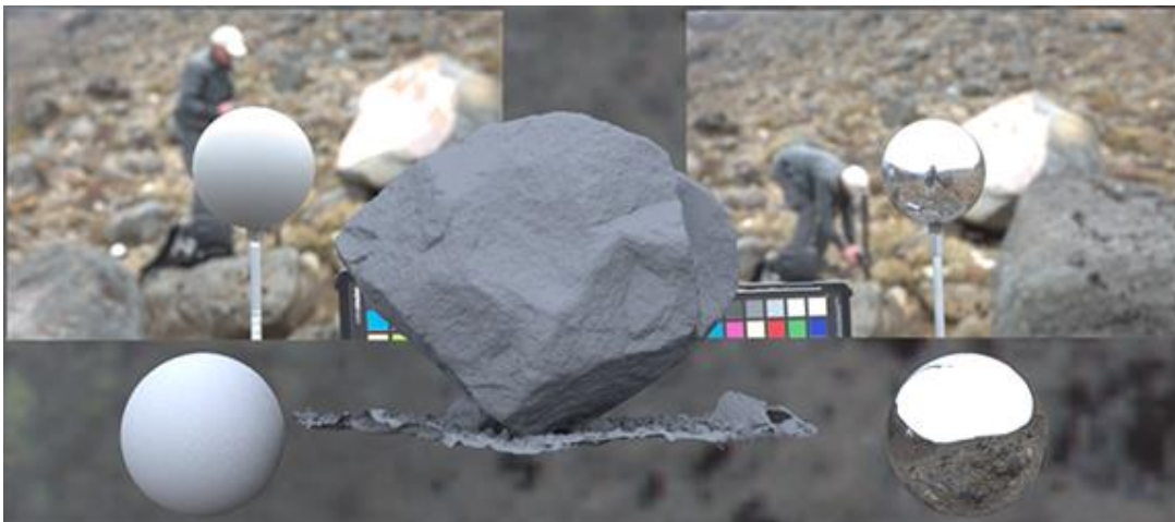
Abbildung 5: HDR/Grey-Chrome Ball Setup (Oh 2015)
