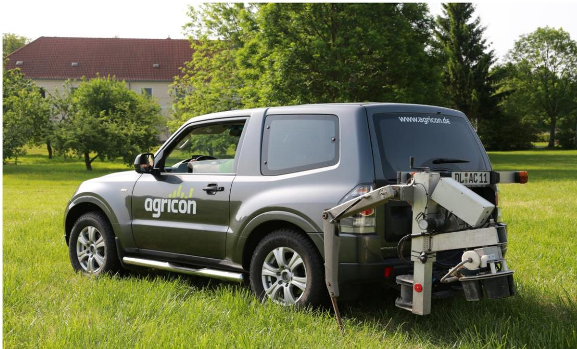
**Abbildung 5: Automatisches Probeentnahmemodul von Agri Con GmbH, angekuppelt an ein geländefähiges Fahrzeug**
