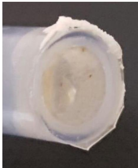
**Abbildung 7:** Bild einer konventionellen Kaliumelektrode, Membran aufgeklebt auf PVC-Rohr
