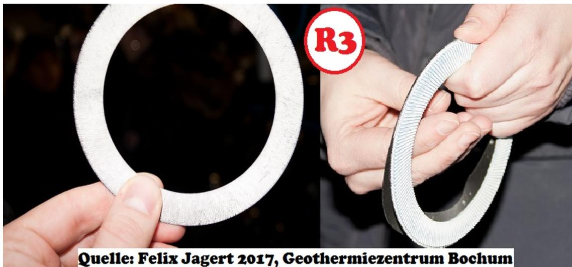
Abbildung 34: Filterringe aus den Filtermodulen
