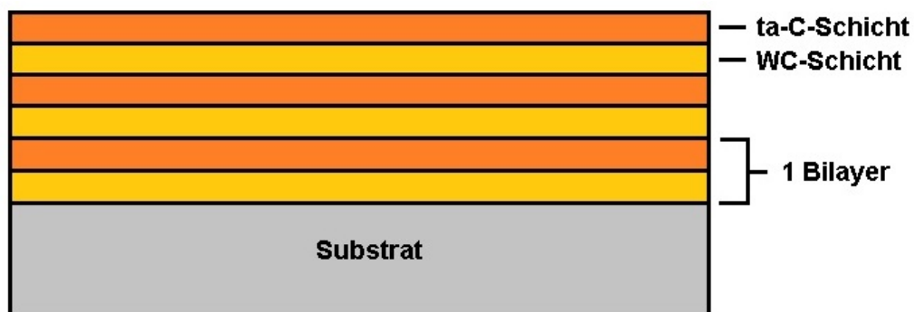
Abbildung 3.3: Schematische Darstellung einer Multilayer-Struktur
