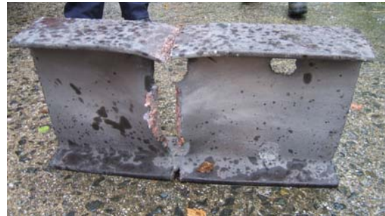
Abb. 5: Ergebnis nach der Metallsprengung 8
