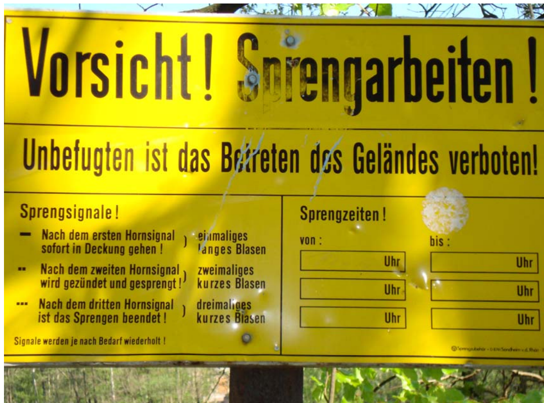
Abb. 14: Warnhinweistafel Sprengarbeiten in Mittweida, Deutschland 92
