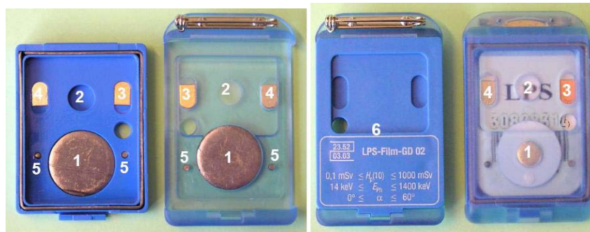
Abbildung 2-5: Aufbau eines Filmdosimeters [12]
