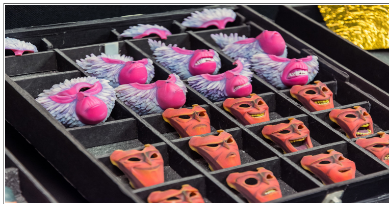
Abbildung 6: Diverse Gesichter und Gesichtshälften angefertigt für den Film KUBO AND THE TWO STRINGS (2016): Die benötigten Mimiken werden zuerst am Computer als 3D-Modelle erstellt und daraufhin mittels eines 3D-Druckers materialisiert. Zu sehen ist außerdem ein Behälter, in welchem die verschiedenen Teile organisiert sind.
