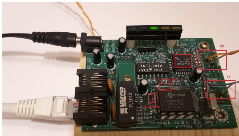
Abbildung 4-7: Mediakonverter 10Base-T to 10Base-FL
