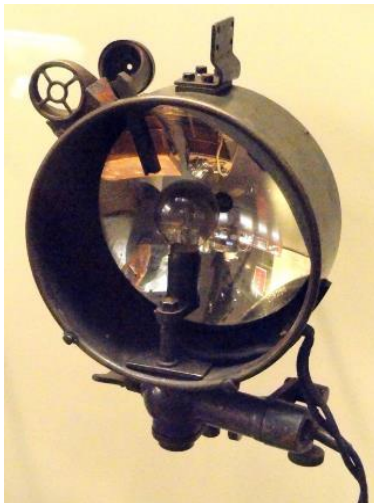
Abbildung 2-2: Blinkgerät 4 und Lichtsprechgerät 80/80 5
