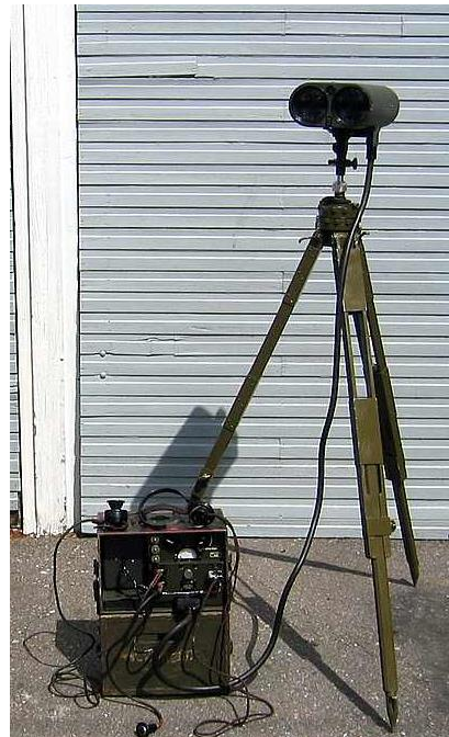
Abbildung 2-2: Blinkgerät 4 und Lichtsprechgerät 80/80 5
