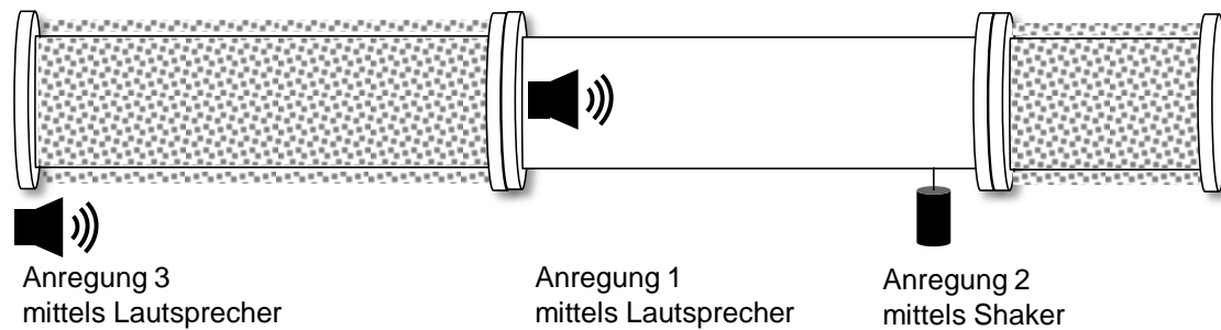
Abbildung 5.4: Messung der Kopplung zwischen Luft- und Körperschall, Schematischer Versuchsaufbau.
