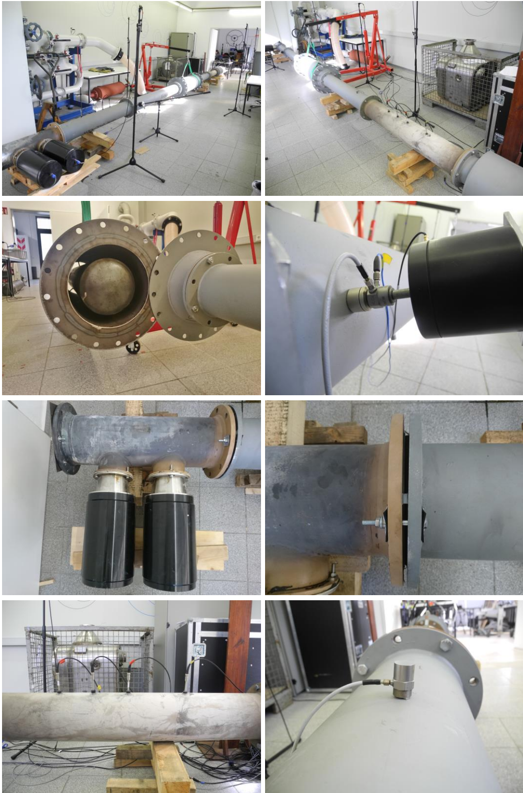
Abbildung A.1: Versuchsaufbau zur Prüfstandsuntersuchung mit Lautsprecher- und Shakeranregung und Schalldruck- sowie Schnellemessung vor und hinter dem Schalldämpfersystem (hier: S 2)
