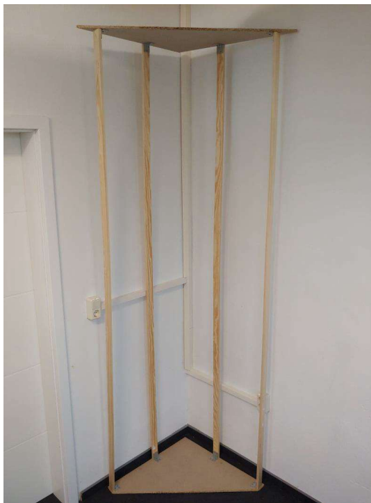
Abbildung 51: Grundkonstruktion des Kantenabsorbers (Quelle: Eigene Darstellung)
