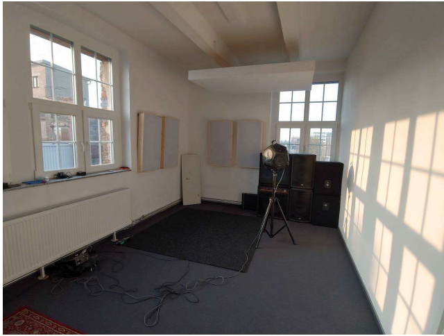
Abbildung 48: Messung der Nachhallzeit; Der Hochttonabsorber in der Raumecke wurde vor der in Abbildung 53 dargestellten Messung entfernt (Quelle: Eigene Darstellung)
