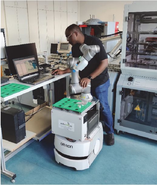
Abbildung 6: Einrichten des mobilen Roboters in der Software MobilePlanner
