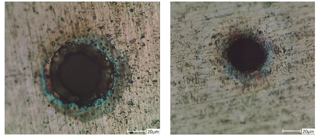
Abbildung 4: Schritt 3 - Strahleintritt links, Strahlaustritt rechts durch Perkussionsbohren mittels Nanosekundenlaser
