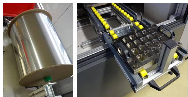
Abbildung 5: Be- und Entladen der Laseranlage mittels Mehrfachvorrichtung zum Laserbohren der Membran
