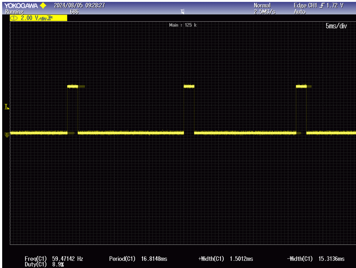
Abbildung 1.2.2: Signal vom Empfänger bei Stillstand
