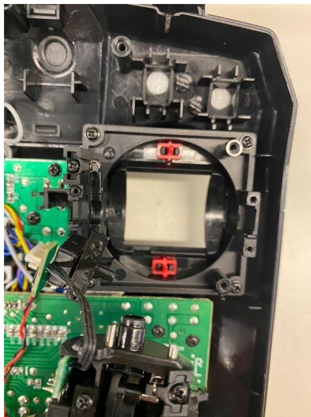
Abbildung 1.1.3: Federinstallation am linken Hebel
