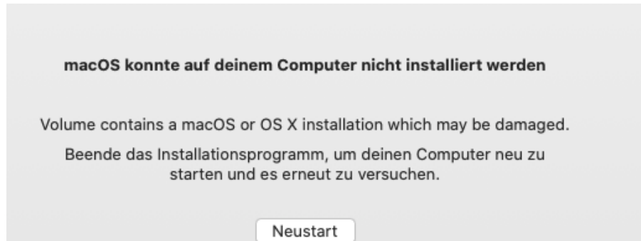
Abbildung 3.12: Abbildung zeigt den Fehler, der bei der Installation auf dem Volume mit gesicherten Ordnern auftritt. Es werden Teile des Volumes als macOS erkannt. (Quelle: Eigene Darstellung)
