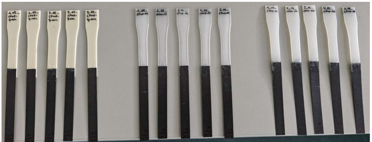
Abbildung B.2.1: Proben nach dem Kleben für HL-Klebstoff für Kombination CFUD-Tape mit Bauteil
