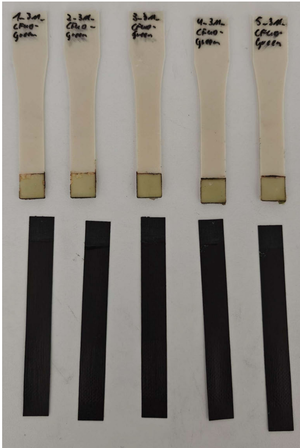
Abbildung C.1.1: Proben nach der Zugscherprüfung: CFUD-Green mit 3M-Klebstoff
