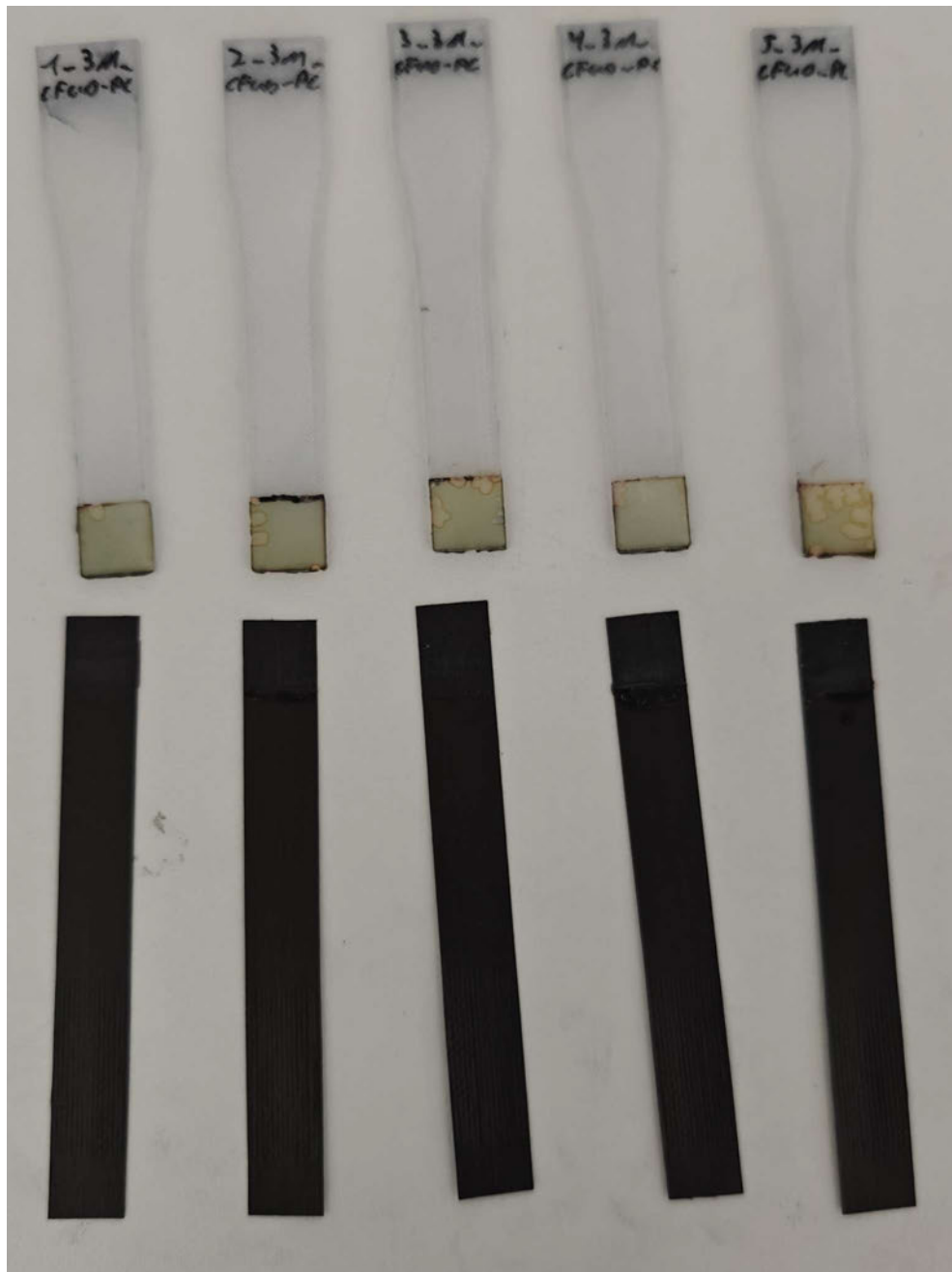
Abbildung C.3.1: Proben nach der Zugscherprüfung: CFUD-PC mit 3M-Klebstoff
