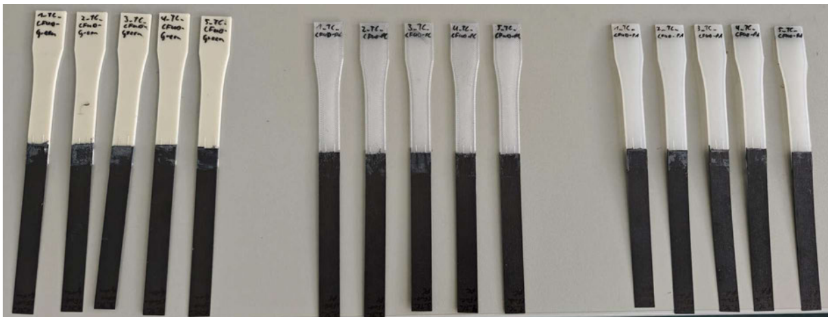
Abbildung B.3.1: Proben nach dem Kleben für TC-Klebstoff für Kombination CFUD-Tape mit Bauteil
