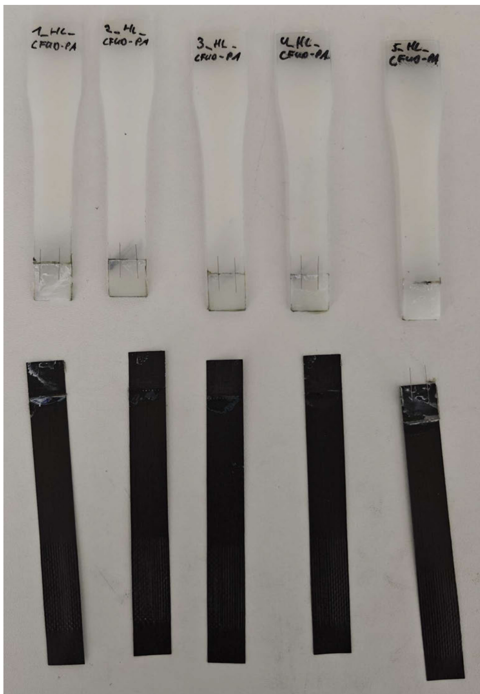
Abbildung C.2.2: Proben nach der Zugscherprüfung: CFUD-PA mit HL-Klebstoff
