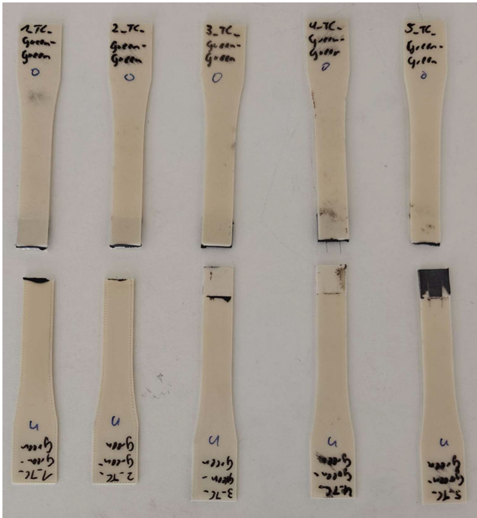
Abbildung C.4.3: Proben nach der Zugscherprüfung: Green-Green mit TC-Klebstoff
