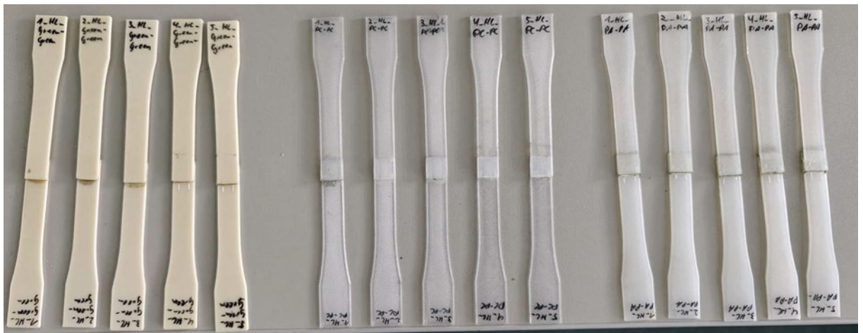
Abbildung B.2.2: Proben nach dem Kleben für HL-Klebstoff für Kombination Bauteil mit Bauteil
