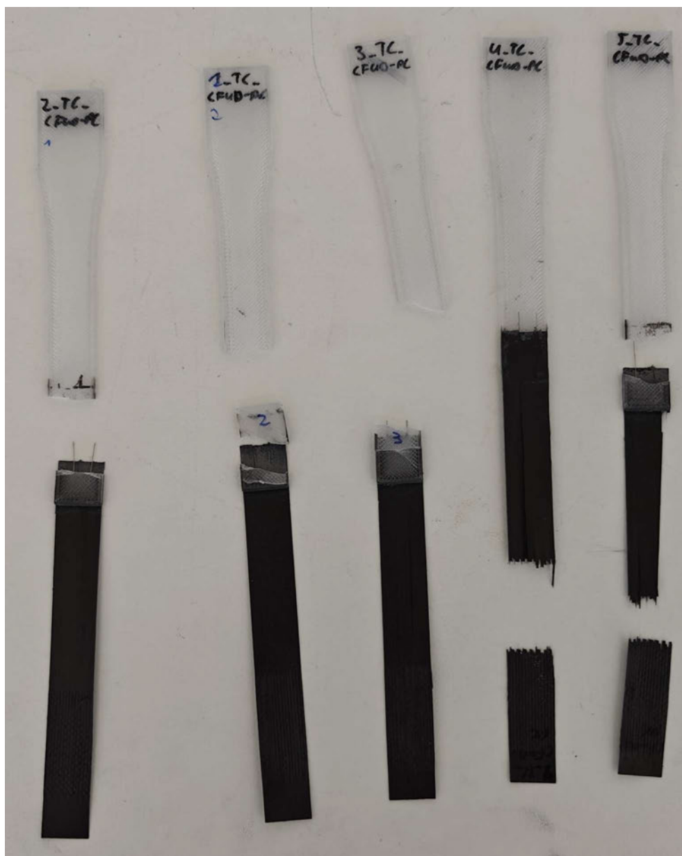
Abbildung C.3.3: Proben nach der Zugscherprüfung: CFUD-PC mit TC-Klebstoff
