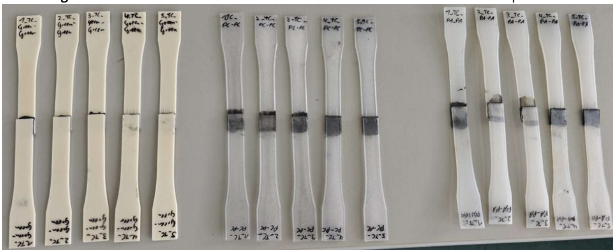
Abbildung B.3.2: Proben nach dem Kleben für TC-Klebstoff für Kombination Bauteil mit Bauteil
