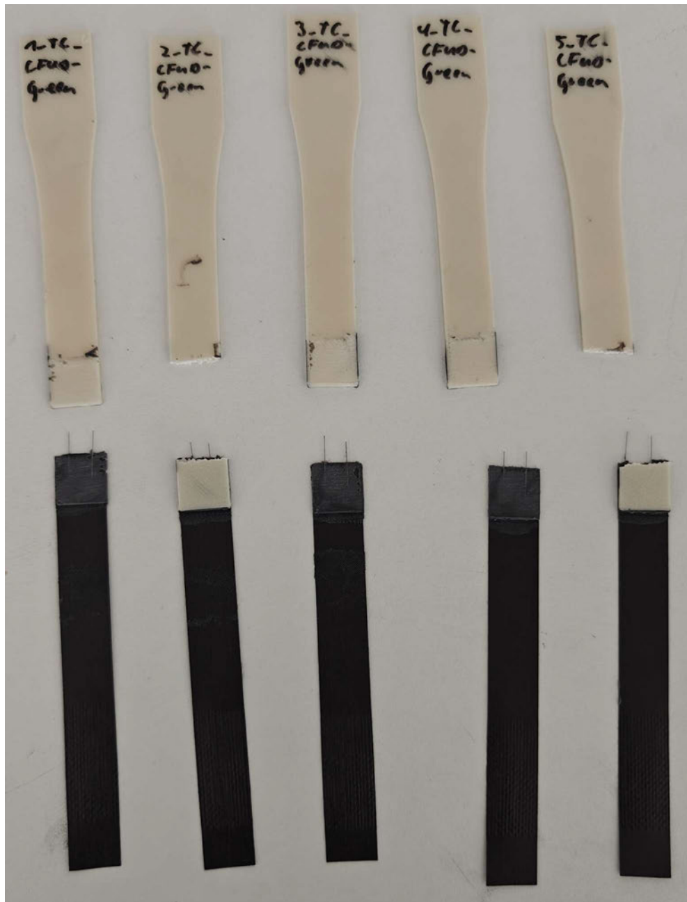
Abbildung C.1.3: Proben nach der Zugscherprüfung: CFUD-Green mit TC-Klebstoff
