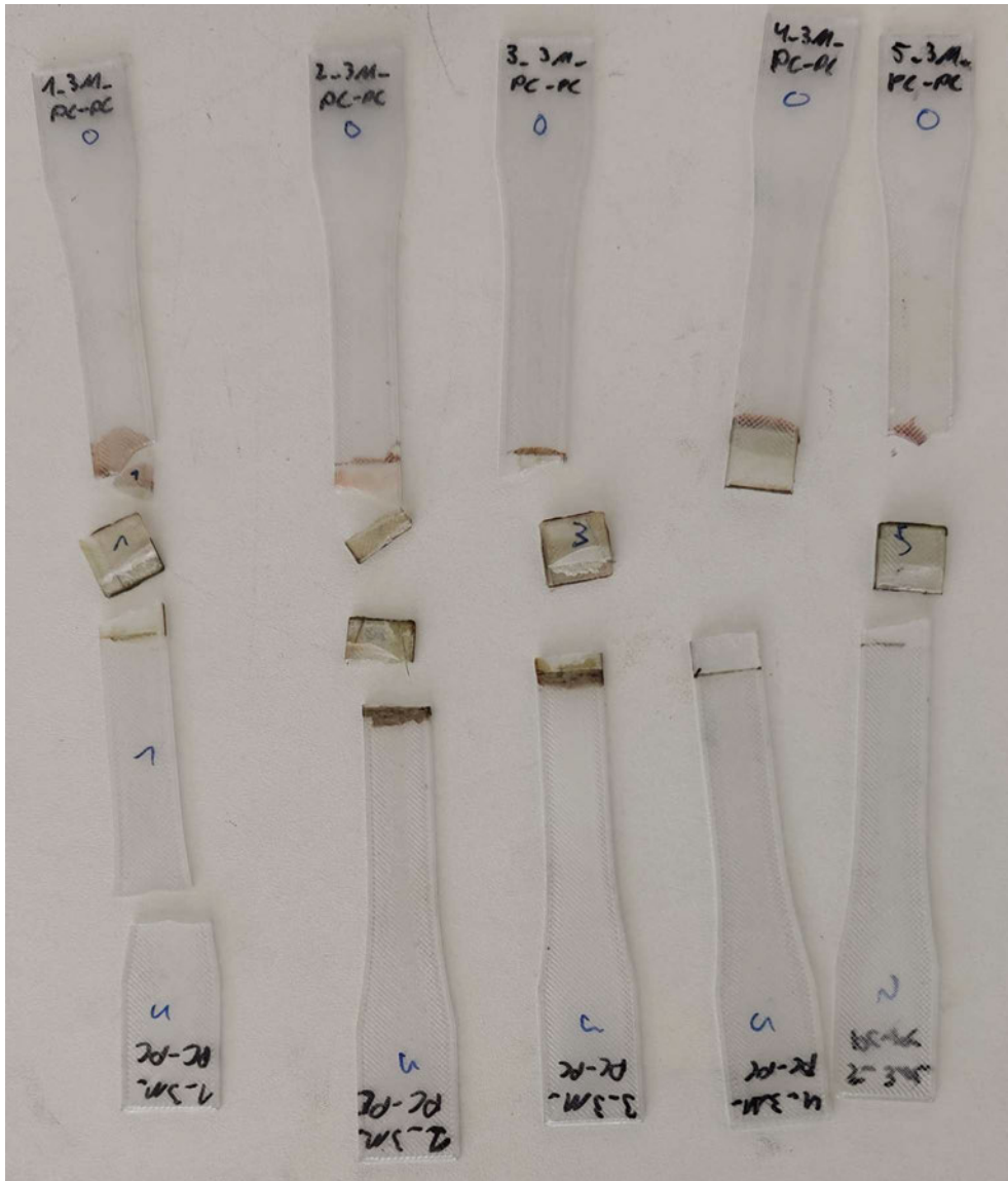
Abbildung C.6.1: Proben nach der Zugscherprüfung: PC-PC mit 3M-Klebstoff
