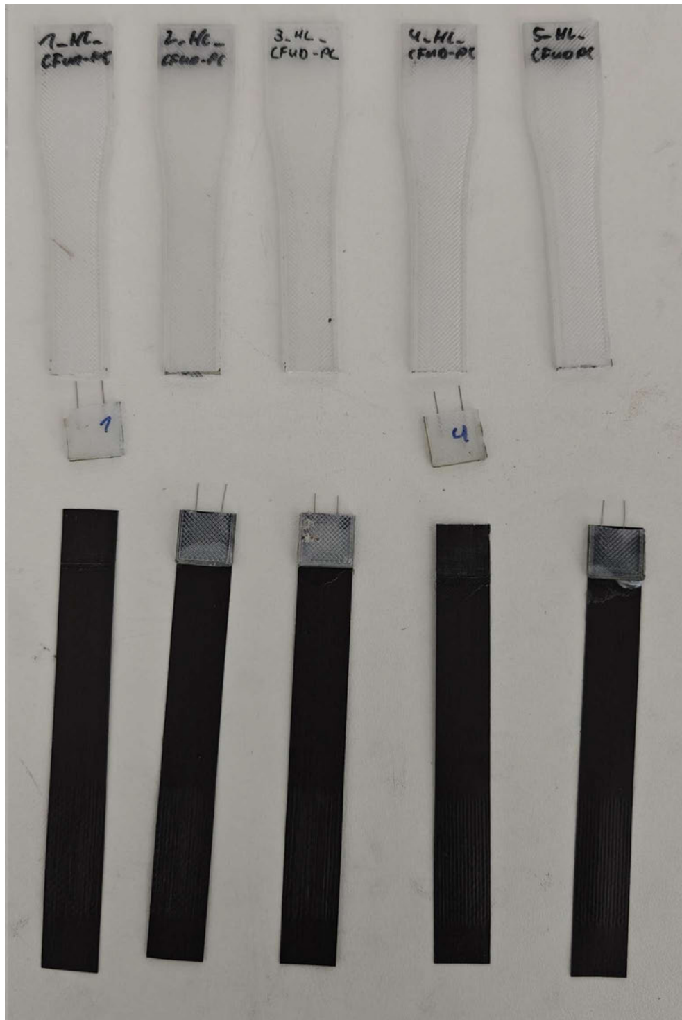
Abbildung C.3.2: Proben nach der Zugscherprüfung: CFUD-PC mit HL-Klebstoff
