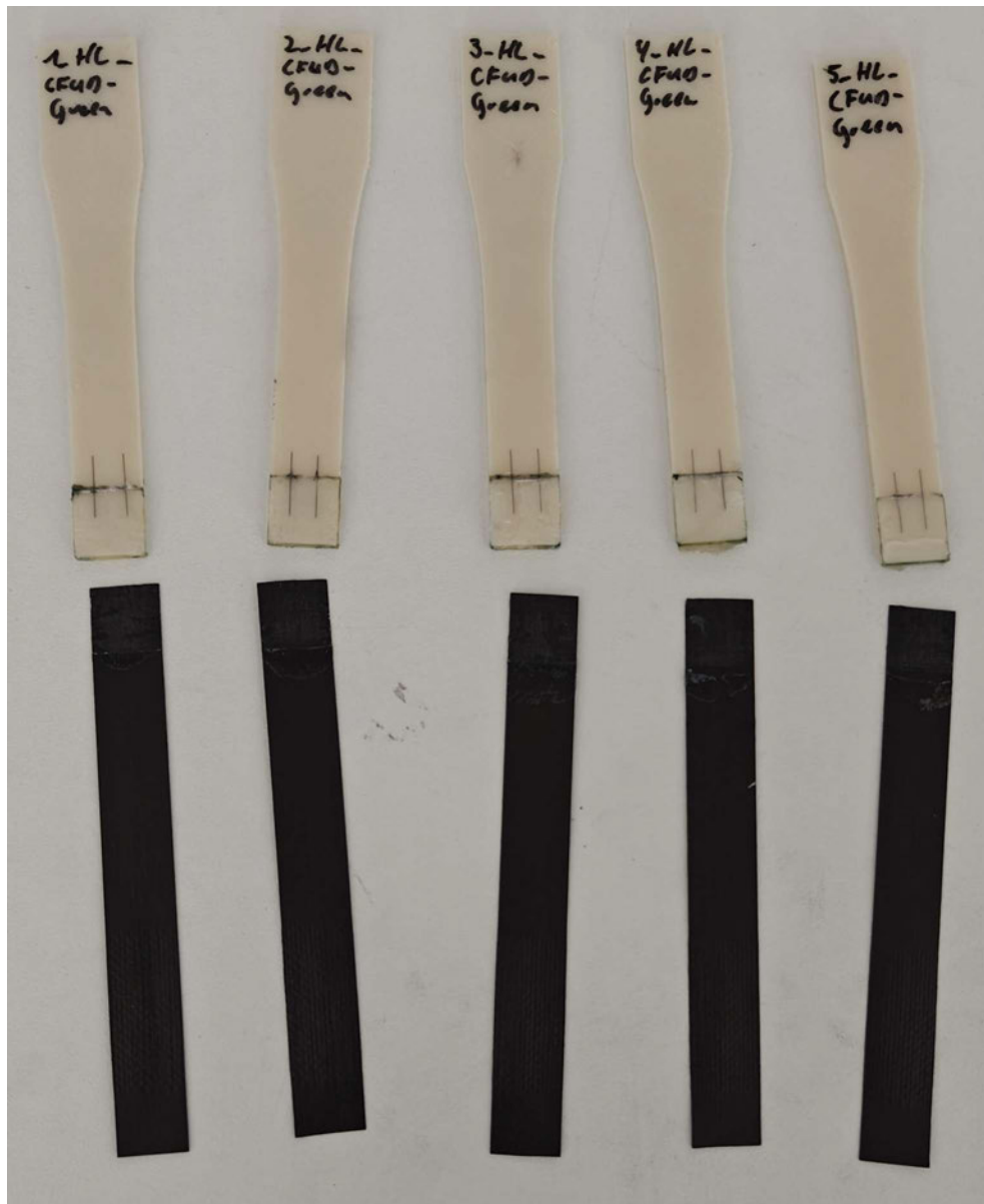
Abbildung C.1.2: Proben nach der Zugscherprüfung: CFUD-Green mit HL-
