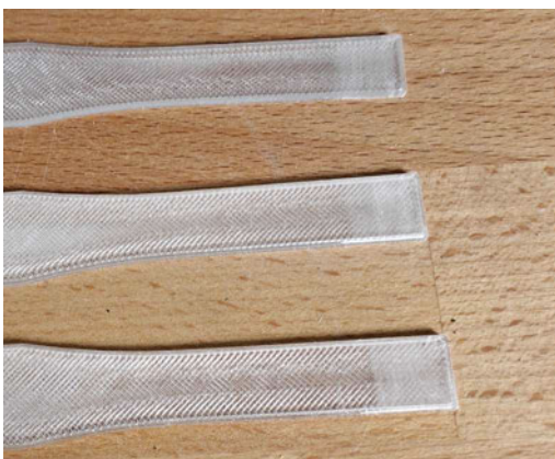
Abbildung 3.2.2: angeschliffene und gesäuberte Füge­teil aus Polycarbonat
