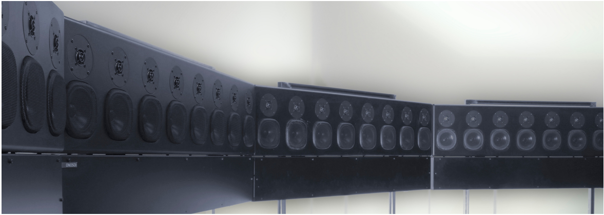
Abb. 4.2.1 - Lautsprecherpanel bestehend aus einer unterschiedlichen Anzahl an einzelnen Lautsprechern
