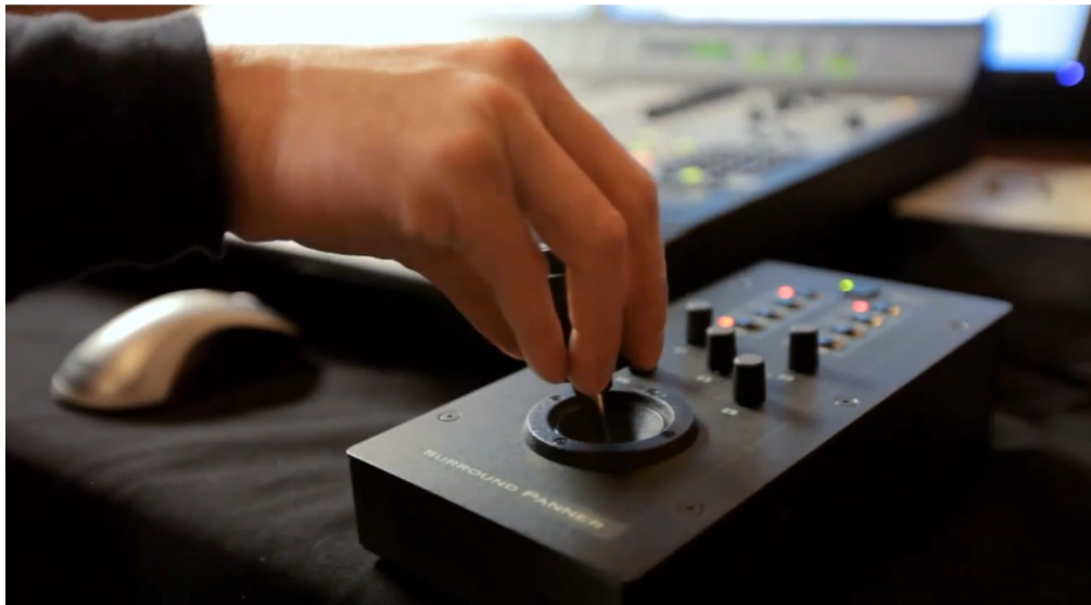
Abb. 3.1.10 - Joystick zur manuellen Kontrolle von Objekten und Keyframeerstellung
